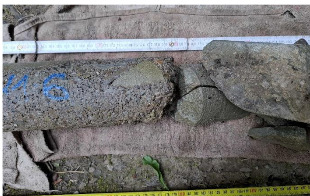
150-200 cm, ložný beton, následuje kámen,
