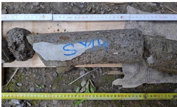
70-110 cm, beton proložený kamenem.
