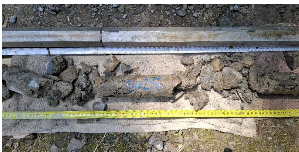
110-170 cm, beton opěry
