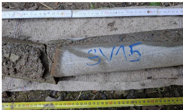
110-150 cm, viditelný kámen a ložný beton.
