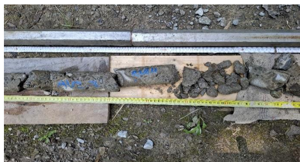
50-110 cm, beton opěry
