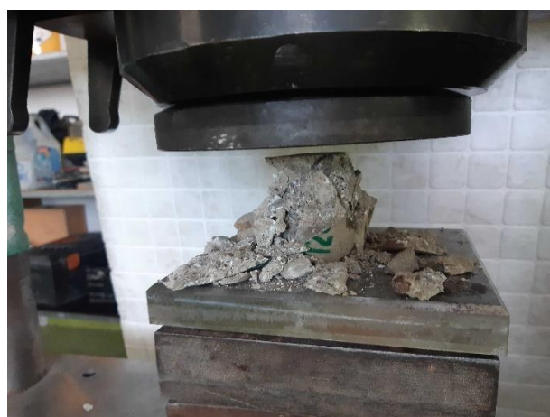
Pohled na porušený vzorek betonu opěry 1205/25 při hodnotě krychelné pevnosti 18,8 MPa.
